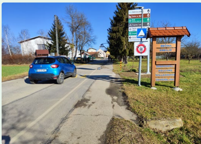
Slika 31: Grbina za umirjanje prometa na občinski cesti LC 169011 (Kobiljska šuma - Kobilje) pred območjem OŠ Kobilje - ukrep za umirjanje hitrosti in povečanje varnosti otrok in drugih udeležencev v prometu
