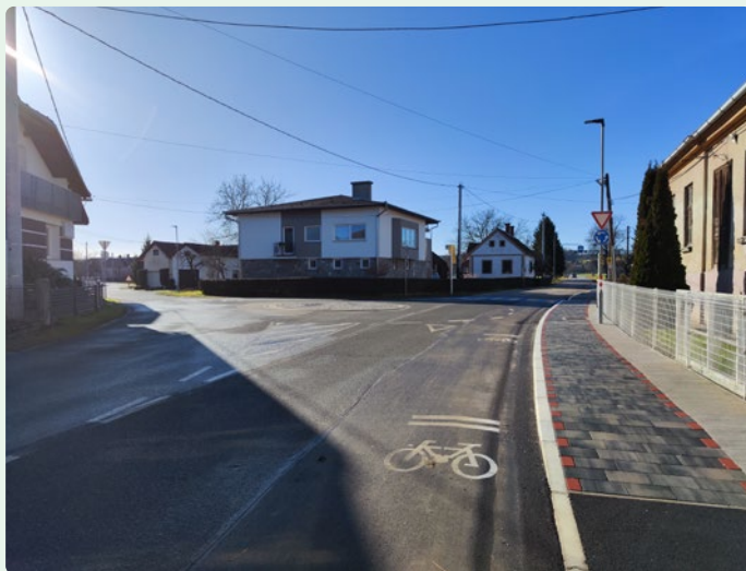
Slika 13: Horizontalna talna označba na občinski lokalni cesti LC-169011 (Kobiljska šuma – Kobilje), ki opozarja na prisotnost kolesarjev na vozišču in s tem povečuje njihovo vidnost ter varnost v prometu
