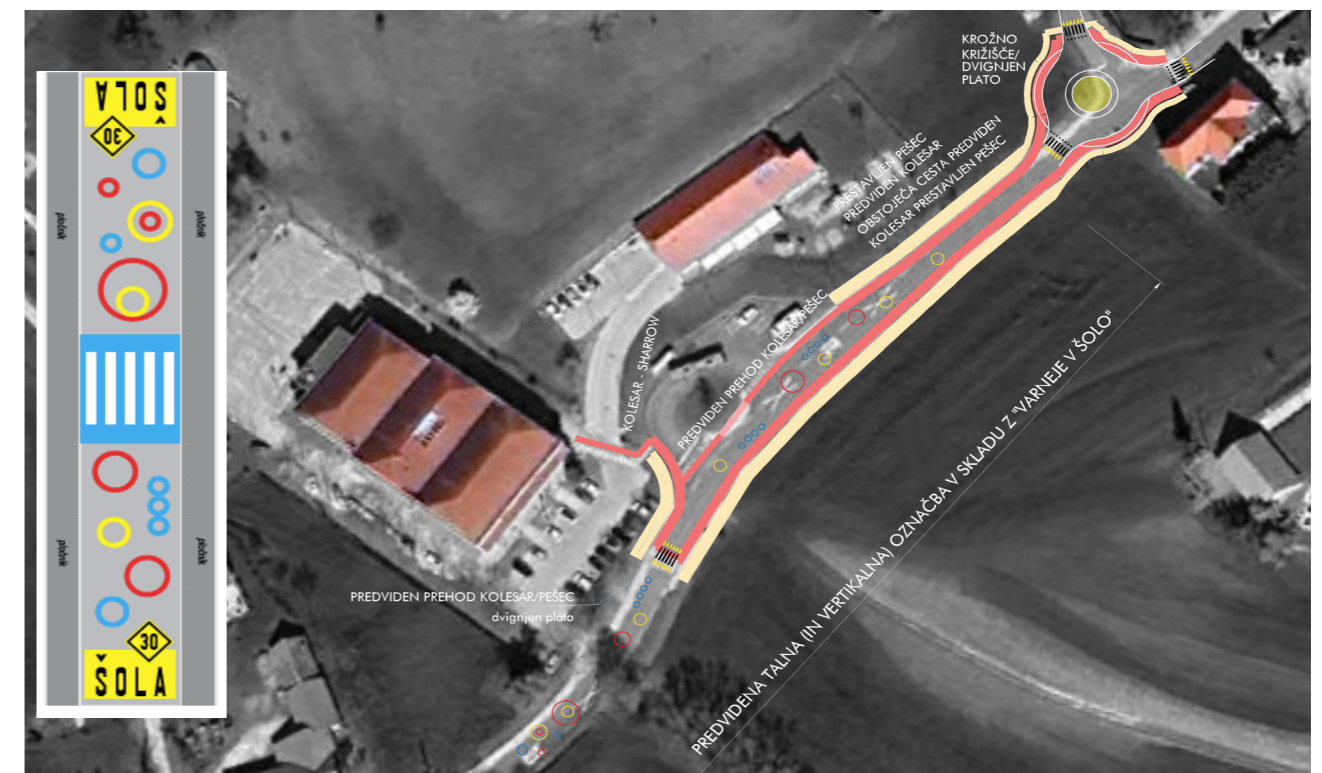
Slika 16: Predlog ureditve cestnega odseka med občinsko stavbo in Osnovno šolo Žetale - obstoječe križišče pred občinsko stavbo se preuredi v krožišče, ob cesti se vzpostavi dvosmerna kolesarska steza, hodnik za pešce se prestavi na zunanji rob kolesarske steze ob zelenico, dodatno se lahko namesti dvignjeni plato na prehodu za pešce pred šolo in dodajo tudi vertikalne in horizontalne označbe.
