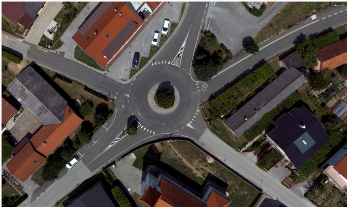
Slika 3: Krožno križišče v Dornavi, ki predstavlja eno glavnih povezav do osnovne šole z južne strani naselja. Kljub temu pešci iz te smeri nimajo urejene in varne poti za dostop do šole
